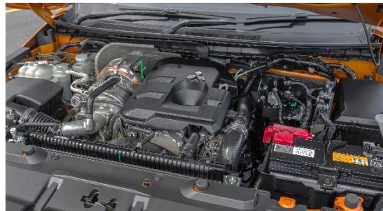
150kW 仕様エンジンルーム
